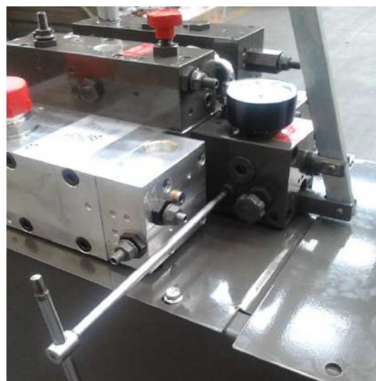
Fig. 17 – Impianti con valvola HDU integrata
